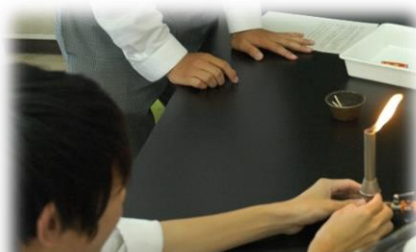
パーミキュライトの加熱実験。熱を加えると鉱物が変形していきます。
